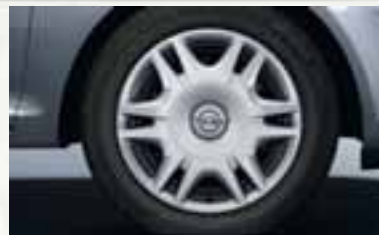
3 Stahlrad inkl. Abdeckung 6 J x 16, Reifen 195/55 R 16 (P2V).
