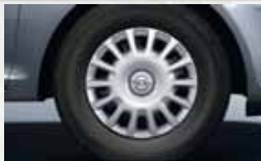
1 Stahlrad inkl. Abdeckung 5 1/2 J x 14, Reifen 185/70 R 14 1 (PA8).
