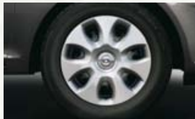
Stahlrad inkl. Abdeckung 6 J x 15, Reifen 185/65 R 15 (QV7).
