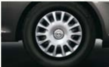
Stahlrad inkl. Abdeckung 5½ J x 14, Reifen 185/70 R 14 sowie 175/70 R 14 (PA8) 1 .
