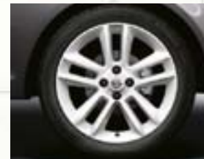
Leichtmetallrad im „5-Doppel- speichen“-Design in Weiß, 7 J x 17 mit Reifen 215/45 R 17 (QV3 & 40P).
