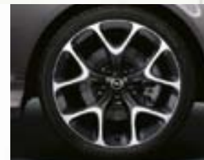
Leichtmetallrad im „5-Y-Spei- chen-OPC“-Design in BiColor, geschmiedet, glanzlackiert in Karbongrau, Speichenrand und Horn glanzveredelt, 7½ J x 18 mit Reifen 225/35 R 18 (PXJ).
