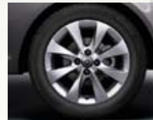
Leichtmetallrad im „Active“- Design, 6 J x 16 mit Reifen 195/55 R 16 (P05).
