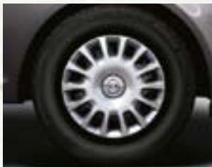
Stahlrad inkl. Abdeckung, 5½ J x 14 mit Reifen 185/70 R 14 sowie 175/70 R 14 (PA8) 1 .
