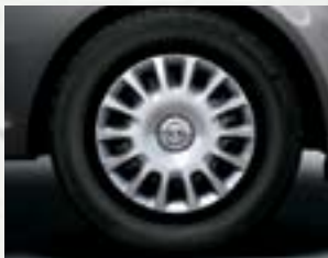
Stahlrad inkl. Abdeckung, 5 1/2 J x 14 mit Reifen 185/70 R 14 sowie 175/70 R 14 (PA8) 1 .
