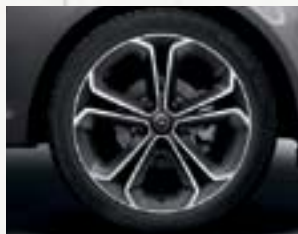
Leichtmetallrad im „5-Doppel- speichen“-Design in BiColor Titanium, 7 J x 17 mit Reifen 215/45 R 17 (PNM).
