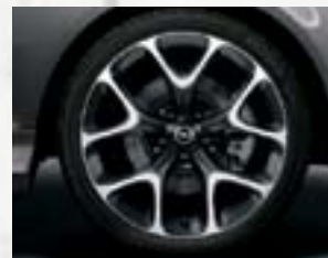
Leichtmetallrad im „5-Y-Spei- chen-OPC“-Design in BiColor, geschmiedet, glanzlackiert in Karbon Grau, Speichenrand und Horn glanzveredelt, 7 1/2 J x 18 mit Reifen 225/35 R 18 (PXJ).
