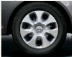
Stahlrad inkl. Abdeckung, 6 J x 15 mit Reifen 185/65 R 15 (QV7).
