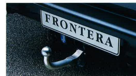
*Variabel: Bei Bedarf ist die Anhänger-Kupplung abnehmbar (nur beim 4tüer).*
