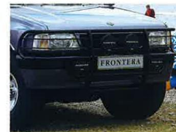
Frontschutzbügel mit Nebelleuchten und Weitstrahlern.
