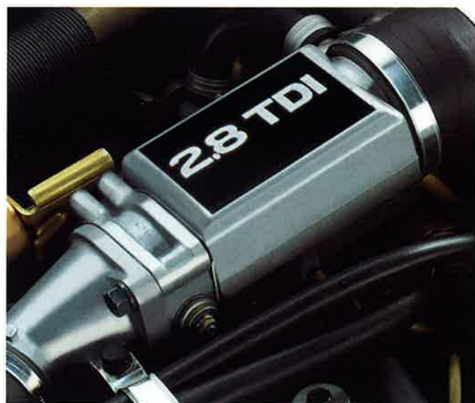
Der 2.8-Liter-Turbodiesel entwickelt eine Leistung von 83 kW (113 PS) und ein maximales Drehmoment von 242 Nm bei 2100 min -1 .
