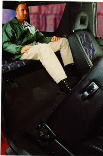
Der Frontera macht das Einsteigen nach hinten sehr bequem. Beim Umklappen der vorderen Beifahrer-Sitzlehne gleitet der ganze Sitz automatisch vor.
