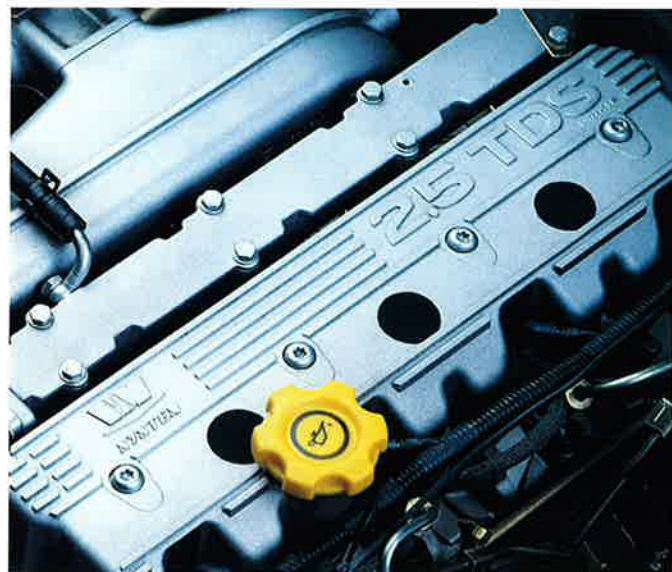
Der 2.5 TDS Diesel mit vollelektronischer Steuerung entwickelt eine Leistung von 85 kW (115 PS) und ein maximales Drehmoment von 260 Nm bei 1800 min -1 .
