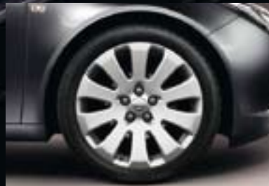
7 Leichtmetallrad 8½ J x 19 im 10-Speichen-Design, Reifen 245/40 R 19 (Q9S).
