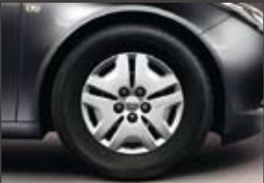
1 Stahlrad 6½ J x 16 inkl. Abdeckung, Reifen 215/60 R 16 (QB5).
