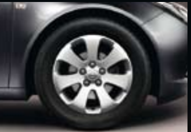
3 Leichtmetallrad 7 J x 17 im 7-Speichen-Design, Reifen 225/55 R 17 (Q00).
