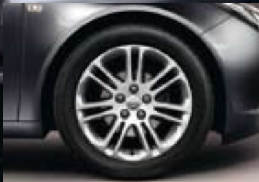
6 Leichtmetallrad 8 J x 18 im 7-Doppelspeichen-Sport-Design, Reifen 245/45 R 18 (Q60).
