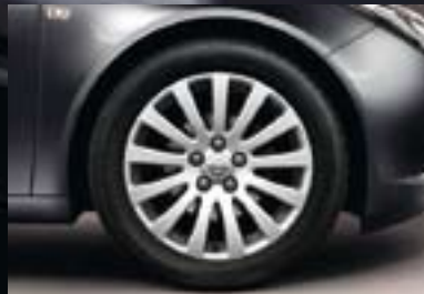
5 Leichtmetallrad 8 J x 18 im 13-Speichen-Design, Reifen 245/45 R 18 (Q56).
