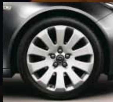
❼ Leichtmetallrad 8½ J x 19 im 10-Speichen-Design, Reifen 245/40 R 19 (Q9S).
