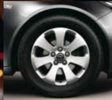
❹ Leichtmetallrad 7 J x 17 im 7-Speichen-Design, Reifen 225/55 R 17 (Q00).
