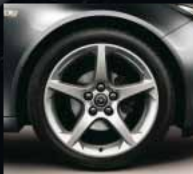
❻ Leichtmetallrad 8½ J x 19 im 5-Speichen-Design, Reifen 245/40 R 19 (Q93).
