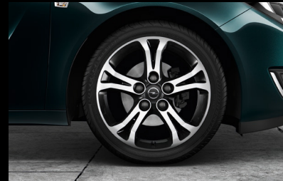
Leichtmetallrad im „5-Doppelspeichen“-Design, BiColor, 8 J x 18 mit Reifen 245/45 R 18 (Q7B).
