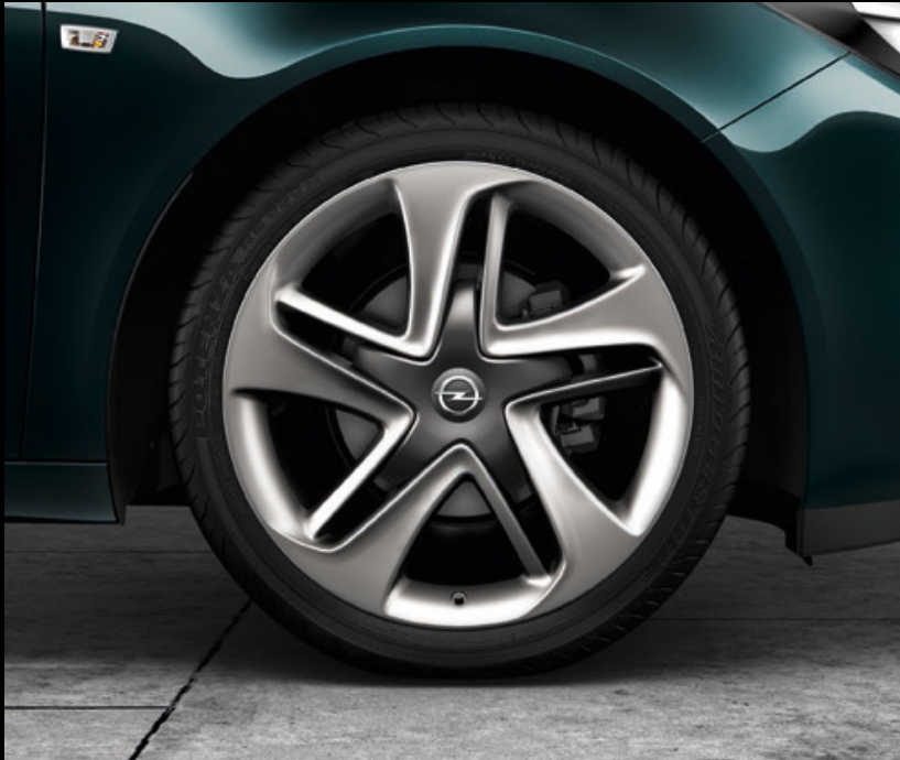
Leichtmetallrad im „5-Sternspeichen“-Design, 8½ J x 19 mit Reifen 245/40 R 19 (WR8).
