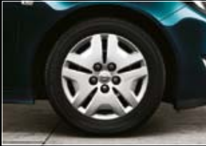
16"-Stahlräder inkl. Radabdeckung, 6½ J x 16 mit Reifen 215/60 R 16 (RRY). 2
