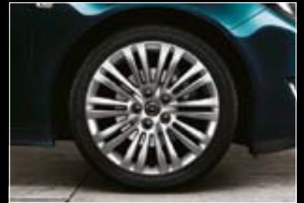
18"-Leichtmetallräder im „10-Doppel- speichen“-Design, 8 J x 18 mit Reifen 245/45 R 18 (RT4). 7
