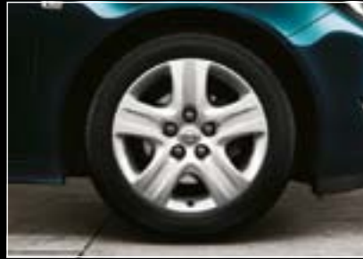
17"-Designräder, 7 J x 17 mit Reifen 225/55 R 17 (RVE). 4
