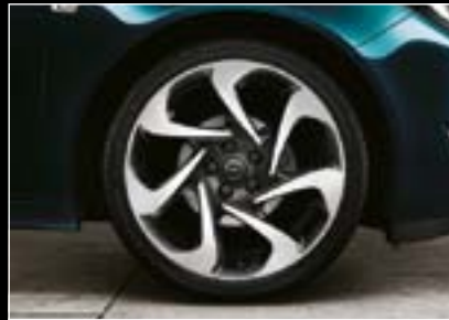
20"-Leichtmetallräder im „7-Speichen“-Design, BiColor, 8½ J x 20 mit Reifen 245/35 R 20 (Q7R). 3
