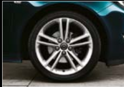
18"-Leichtmetallräder im „Doppel- speichen-Sport“-Design, 8 J x 18 mit Reifen 245/45 R 18 (RV1). 7
