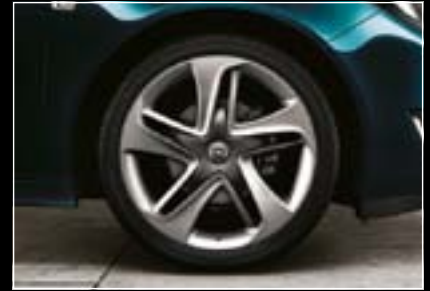
19"-Leichtmetallräder im „5-Sternspeichen“-Design, 8½ J x 19 mit Reifen 245/40 R 19 (WR8). 3 Oder 8½ J x 19 mit Reifen 245/45 R 19 (WR8 & RKQ). 2
