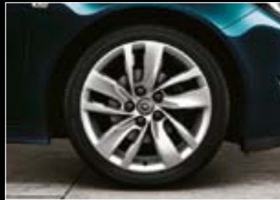
18"-Leichtmetallräder im „5-Doppel- speichen-Rotor“-Design, 8 J x 18 mit Reifen 245/45 R 18 (PXR). 8
