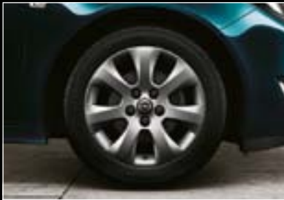
17"-Leichtmetallräder im „7-Speichen“- Design, 7 J x 17 mit Reifen 225/55 R 17 (RSB). 6
