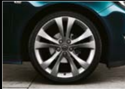
20"-Leichtmetallräder im „5-Doppelspeichen-Stern“-Design, mehrfach beschichtete Premium-Farboberfläche, 8½ J x 20 mit Reifen 245/35 R 20 (RTH). 3
