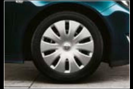
17"-Stahlräder inkl. Radabdeckung im „10-Speichen“-Design, 7 J x 17 mit Reifen 225/55 R 17 (RS9). 5
