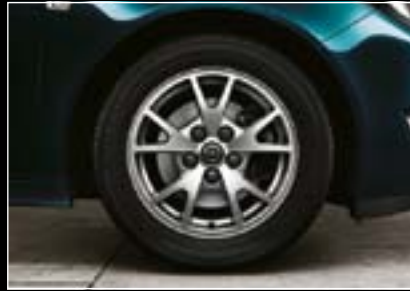
16"-Leichtmetallräder im „Doppel- speichen“-Design, 6½ J x 16 mit Reifen 215/60 R 16 (RRZ). 3
