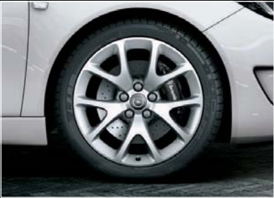
Leichtmetallrad im „5-Speichen-OPC“-Design, glanzveredelt, 8½ J x 19 mit Reifen 245/40 R 19.
