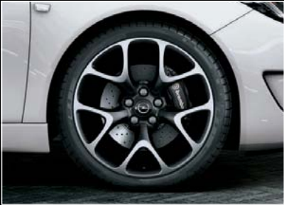
Leichtmetallrad im „5-Y-Speichen-OPC“-Design, Bi-Color, geschmiedet, glanzlackiert in Karbon-grau, Speichenrand und Horn glanzveredelt, 8½ J x 20 mit Reifen 255/35 R 20.
