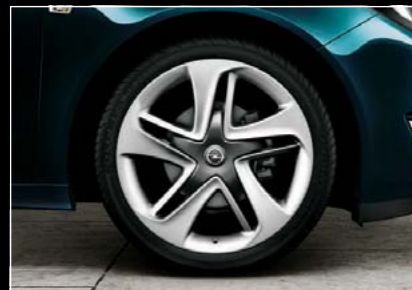
19"-Leichtmetallräder im „5-Sternspeichen“-Design, 8 1/2 J x 19 mit Reifen 245/40 R 19 (WR8). 3 Oder 8 1/2 J x 19 mit Reifen 245/45 R 19 (WR8 & RKQ). 2
