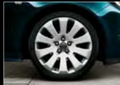
19"-Leichtmetallräder im „10-Speichen“-Design, glanzveredelt, 8 1/2 J x 19 mit Reifen 245/40 R 19 (Q7V).
