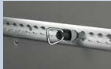
Verschiebbare Verzurrösen. Spezielle für das Opel Movano Schienensystem entwickelte Verzurrösen aus Metall.
