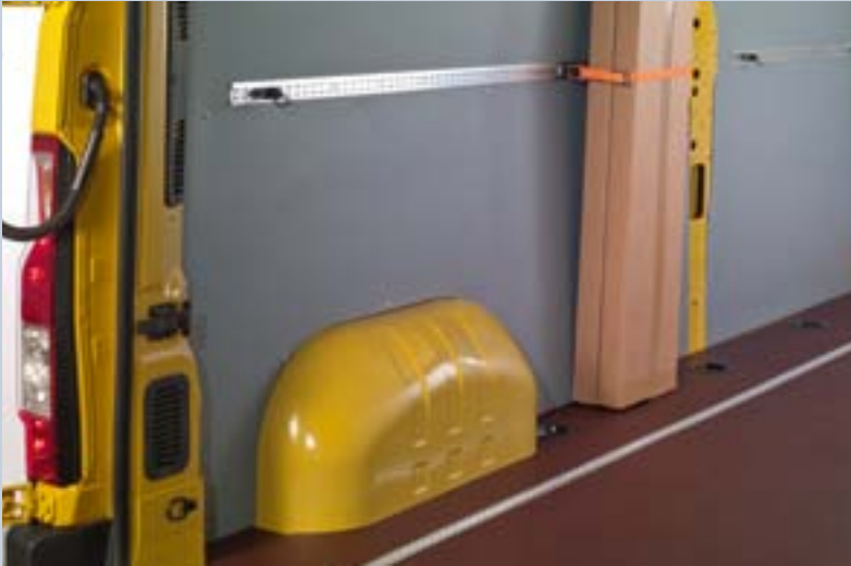
Fixierbänder. Flexible Bänder zur platzsparenden Ladungssicherung an den seitlichen Verzurrschienen.
