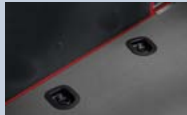
Starre Verzurrösen im Ladeboden. 6, 8, 10 oder 12 Verzurrösen im Ladeboden (variiert nach Fahrzeuglänge). 4 seitliche Verzurrösen sind optional erhältlich.
