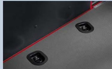
Verzurrösen. Je nach Fahrzeuglänge sichern 6, 8, 10 oder 12 auf dem Boden montierte stabile Verzurrösen die Ladung. 4 seitlich montierte Verzurrösen sind optional erhältlich.
