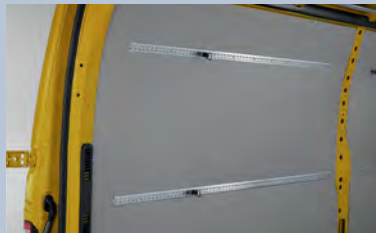
Seitliche Verzurrschienen. Mit 6 verschiebbaren Verzurrösen und Befestigungspunkten alle 25 mm.
