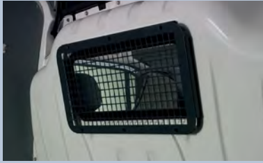
Schutzgitter für verglaste Trennwand. Das stabile Stahlgitter schützt die Trennscheibe, ohne die Sicht zu behindern.
