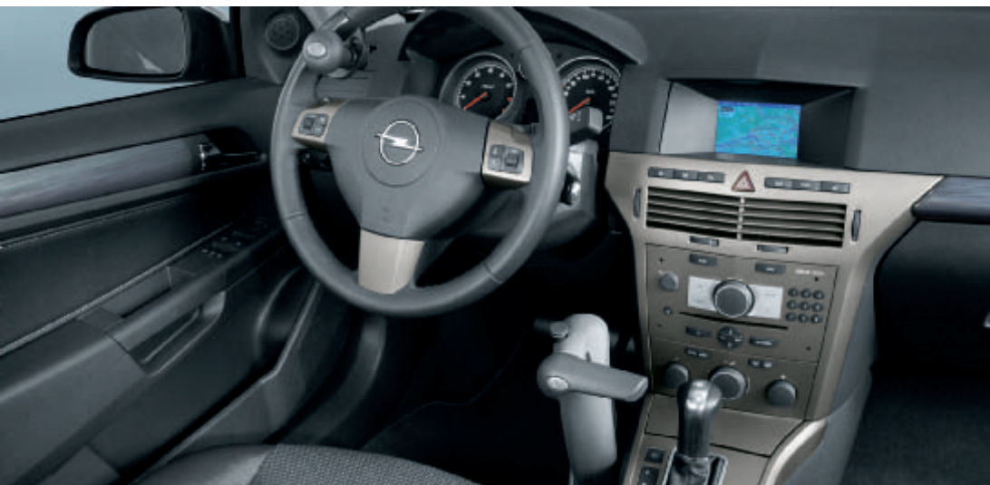
Opel Astra-Cockpit mit Handbediengerät für Gas/Bremse und Lenkraddrehknopf
