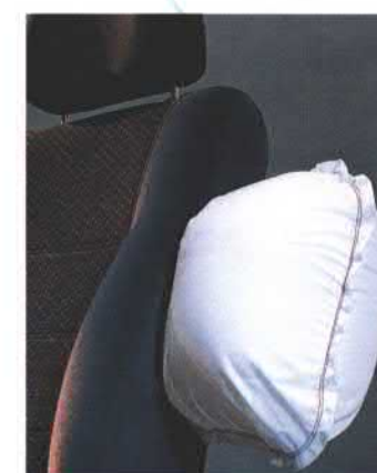
Die serienmäßigen Seitenairbags befinden sich bei jeder Sitzeinstellung immer in der idealen Schutzposition zum Fahrer bzw. Beifahrer. Die Auslösesensoren sitzen dort, von wo die meiste Gefahr droht: in den vorderen Türen.
