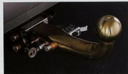
Der Vorteil der abnehmbaren Anhängerzugvorrichtung: Sie läßt sich mit einfachen Handgriffen an- und abmontieren - je nach Bedarf wird sie in einer speziellen Konsole im Wagen gelagert.
