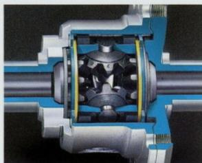
**Sperrdifferential:** Auf unbefestigtem oder einseitig glattem Untergrund wird „Durchdrehen“ und „Festfahren“ eines Rades verhindert. Nützlich z. B. auf Campingplätzen oder bei winterlichen Bodenverhältnissen.
