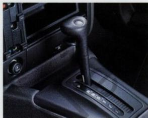
**Automatic:** Ermöglicht ruckfreies, weiches Anfahren auch am Berg. Verhindert Durchrutschen der Kupplung. Einfach Gang einlegen, Vollgas geben, Handbremse lösen – der Wandler der Automatic sorgt bei niedrigen Fahrgeschwindigkeiten für ein gutes Motor-drehmoment.
