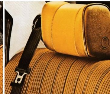
**Kopfstützen und 3-Punkt-Automatikgurte hinten**
