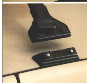
Beide Dachschild-Adapter sind diebstahlsicher abschließbar (Abb. Kienzle-Dachschild).
