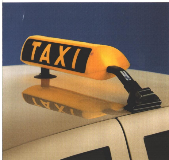
Beide Dachschild-Adapter sind diebstahlsicher abschließbar (Abb. Kienzle-Dachschild).
