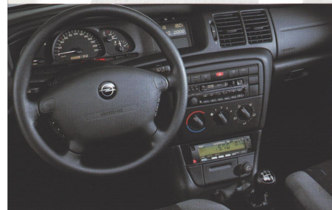
Taxametervorrichtung in der Mittelkonsole, komplett mit Impulsabgriff verkabelt.
