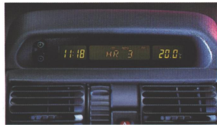
Digitale Anzeige von Uhrzeit, Datum bzw. Radiosender und Außentemperatur.
