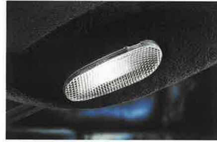
Gefahr erkannt, Gefahr gebannt. Beim Öffnen der Türen leuchten automatisch die Lampen an der Innenseite auf.
