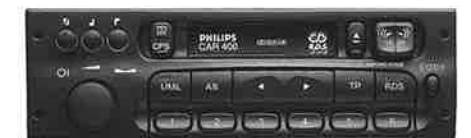
Zu den besonderen Vorzügen des Radios Philips CAR 400 gehören das abnehmbare Bedienteil, das integrierte Cassetten-deck mit Programmsuchsystem, geschwindigkeitsabhängige Lautstärkeregelung, Dolby „B“ und Autoreverse sowie die Telefonvorbereitung (Sonderausstattung).
