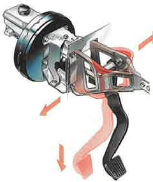
PRS (Pedal Release System): Mit dieser Konstruktion wird bei Frontalkollisionen ein Eindringen der Pedale in den Fahrgastraum verhindert.
