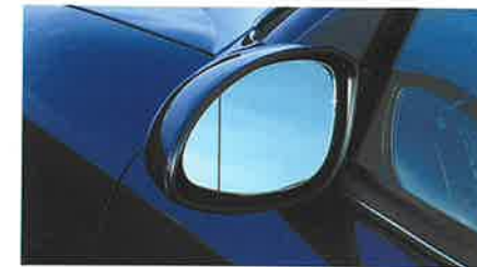
Rückblick ohne Eis und tote Winkel: Der asphärische, elektrisch einstellbare und beheizbare Außenspiegel ist
