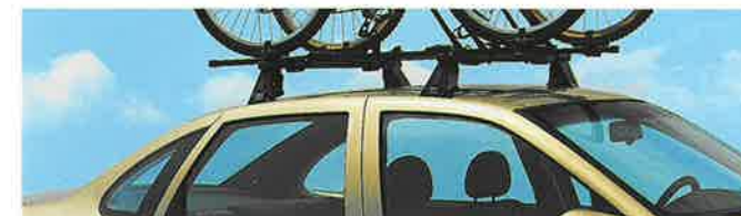
Fahrräder werden bereits am Boden auf den Fahrradträger montiert und erst dann bequem auf den Basisträger gesetzt.
