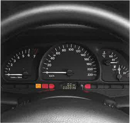
Die elektronische Steue- rung des Tachometers macht es möglich, die Geschwindigkeit beim Vectra schon ab 4 km/h genau anzuzeigen, so daß sich Tempolimits besser einhalten lassen.
