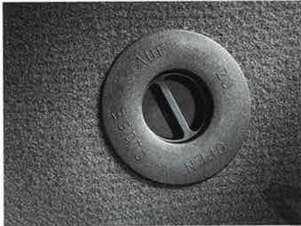
Wirkungsvolle Maß- nahme gegen Diebstahl: Die Rücksitzlehne des Vectra ist vom Koffer- raum aus verriegelbar.
