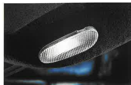
Gefahr erkannt, Gefahr gebannt. Beim Öffnen der Türen leuchten automatisch die Lampen an der Innenseite auf.
