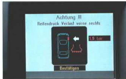
■●▲ Das Reifendruckkontrollsystem. Ein möglicher Druckverlust wird im Display des Drehzahlmessers bzw. mit Angabe des entsprechenden Rades im Graphic Info Display (GID) oder im Color Info Display (CID) angezeigt.
