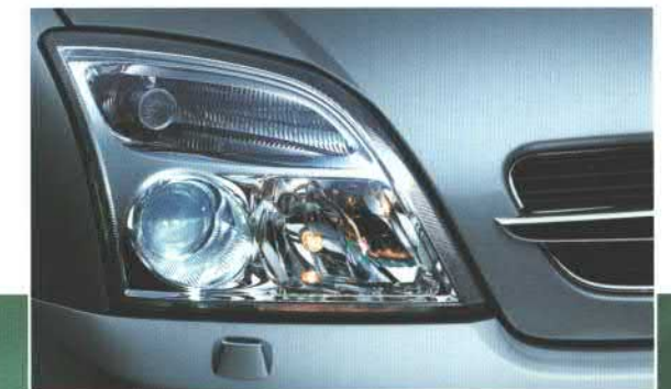
■●▲ Immer beste Sicht nach vorn. Xenon-Scheinwerfer mit automatischer Leuchtweitenregulierung und Scheinwerfer-Hochdruck-Reinigungsanlage.
