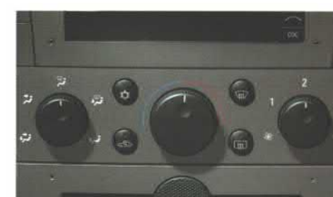
■○△ Serienmäßig ab dem Vectra Comfort. Die FCKW-freie Klimaanlage mit manueller Umlufschaltung und Partikelfilter.
