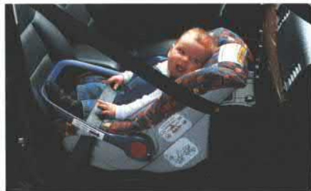
■●▲ Die Sitzbelegungserkennung verhindert das Auslösen von Full Size Front- und Seitenairbag auf der Beifahrerseite, wenn eine Opel Kindersicherheitswiege mit Transponder montiert ist.
