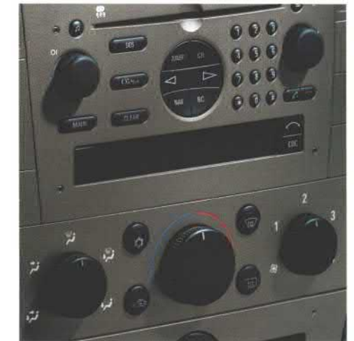
Serienmäßig an Bord: die FCKW-freie Klimaanlage mit manueller Umluftschaltung und Partikelfilter.
