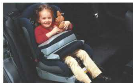
□○△ Die Vorrichtung für das Kindersitzbefestigungssystem „ISOFIX“ verbindet einen mit dem „ISOFIX“ System ausgerüsteten Kindersitz direkt mit der Fahrzeugkarosserie. Durch diese feste Karosserieanbindung hat auch das kleinste Familienmitglied immer den größtmöglichen Schutz.
