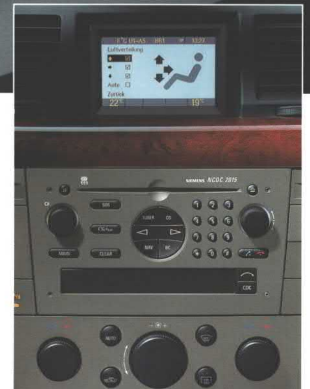
■●▲ Hightech-Alternative. Die hochpräzise Klimatisierungsautomatik mit Temperaturvorausberechnung und getrennter Regelung für Fahrer- und Beifahrerseite. Spezielle Funktionen werden über das monochrome Graphic Info Display (GID) oder optional über das farbige Color Info Display (CID) eingestellt.
