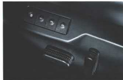
■●▲ Die elektrisch einstellbaren Vordersitze verfügen über eine Memoryfunktion für Fahrersitz-, Außen- und Innenspiegelposition.
