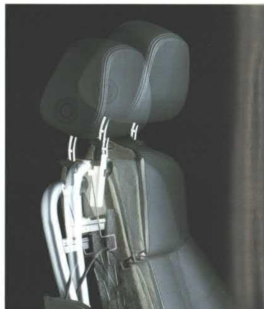
Entscheidendes Sicherheitsplus in den Vordersitzen. Neue aktive Kopfstützen mit Lehnenunterstützung reduzieren das Risiko von Nackenverletzungen ganz erheblich.
