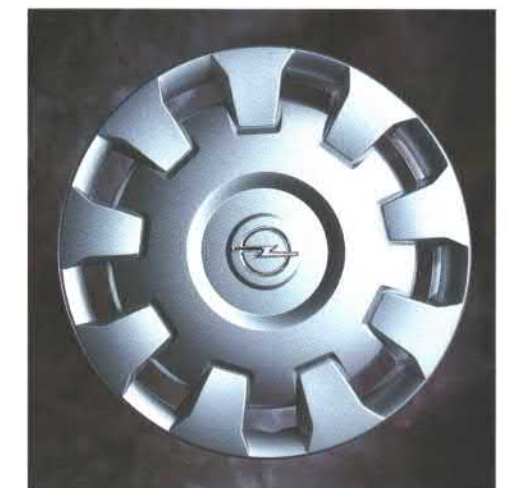
Die Stahlräder 6 1/2 J x 16 mit ganzflächigen Radabdeckungen. Die Reifen haben die Größe 215/55 R 16.
