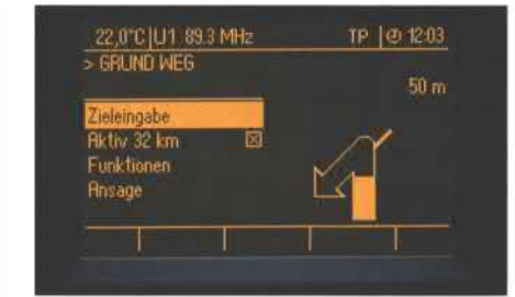
■●▲ Alle Navigationssysteme verfügen über eine dynamische Routenführung. Die Anzeige erfolgt als Symboldarstellung auf dem monochromen Graphic Info Display (GID) bzw. auf Wunsch auch als Kartendarstellung auf dem farbigen Color Info Display (CID).
