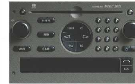
■●▲ Radio NCDC 2013: Stereo-CD-Radio mit Navigationssystem, integriertem 4fach CD-Wechsler und Graphic Info Display (GID). Auf Wunsch mit Kartendarstellung auf dem Color Info Display (CID).
