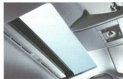
■●▲ Das elektrische Schiebe-/Ausstelldach mit Positionsvorwächler und Einklemmschutz lässt sich auch per Fernbedienung öffnen und schließen.
