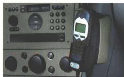
Hervorragende Sprachqualität. Die fest installierte Telefonkonsole mit Freisprecheinrichtung und Außenantennenanschluss.
