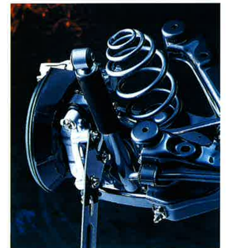
Die kompakte 4-Lenker-Hinterachse mit jeweils drei Querlenkern und einem Längslenker sowie Leichtbauteilen aus Aluminium.
