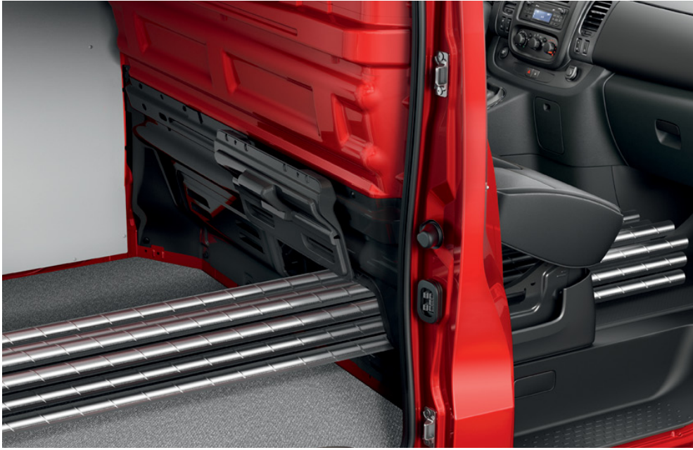
FLEXCARGO®-TRENNWAND. Die Durchladeeinrichtung erlaubt den sicheren Transport von bis zu 4,15 m langem Ladegut mit geschlossenen Hecktüren.
