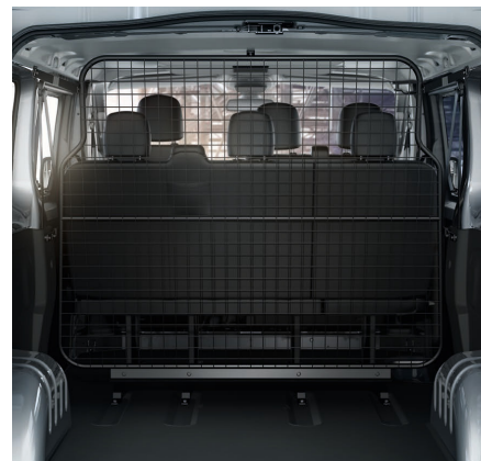
GITTERTRENNWAND. Der hochbelastbare Schutz vor Ladung erlaubt uneingeschränkte Sicht nach hinten.
