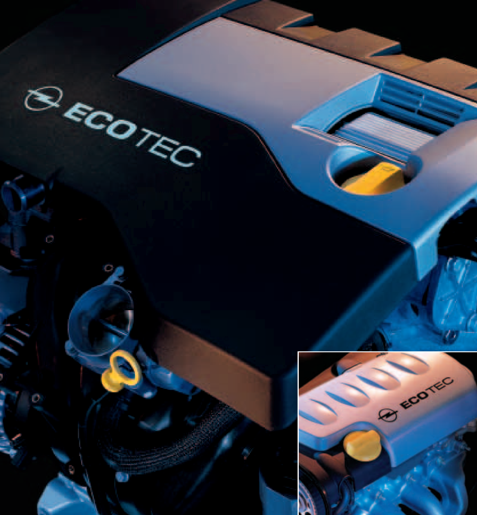
Performance pur: Der 2.2 ECOTEC® leistet 108 kW (147 PS) und wird auf Wunsch mit 4-Gang-Automatikgetriebe geliefert.
