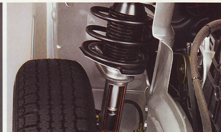
Federbein-Vorderrad-Aufhängung nach dem McPherson-Prinzip
