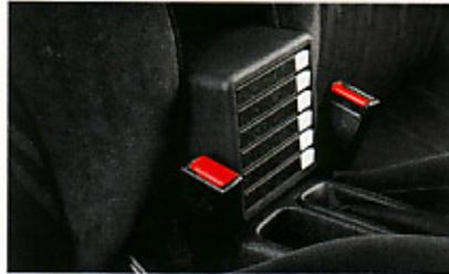
handbedienung schützt bis zu 6 Cassetten vor Staub, Licht und Sonne. Die Montage erfolgt auf der
