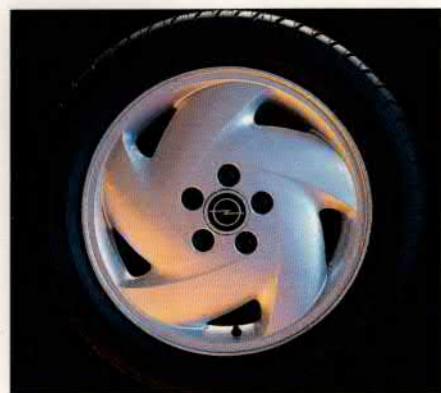
Die Leichtmetallräder, 6 J x 16, (speziell für den Calibra turbo) sind mit Reifen der Größe 205/50 ZR16 ausgestattet.
