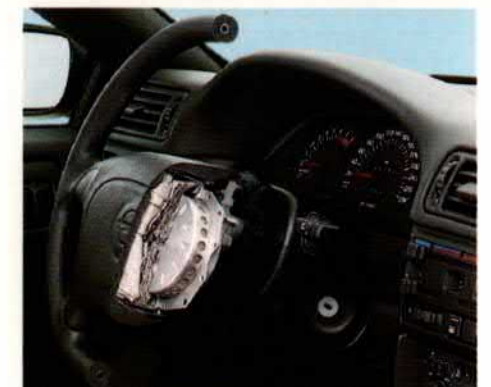
Der zusammengefaltete Airbag im Pralltopf des Lenkrades.
