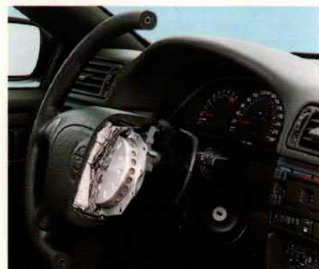
Der zusammengefaltete Airbag im Pralltopf des Lenkrades.
