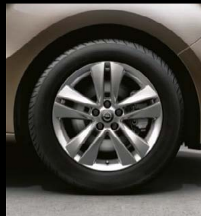
Leichtmetallrad 6 J x 16, Reifen 195/60 R16. 4
