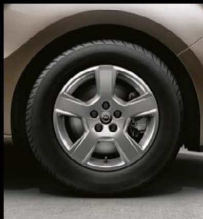
Leichtmetallrad 6 J x 15, Reifen 195/65 R15. 3
