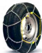
**Robuste 12-mm-Kette mit automatischer Doppelspannung**
