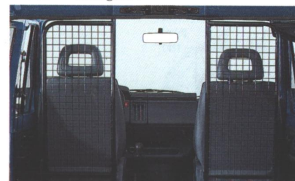
Zusätzliche Sicherheit für Fahrer bzw. auch Beifahrer: \frac{1}{3} - oder \frac{2}{3} -Trenngitter.
