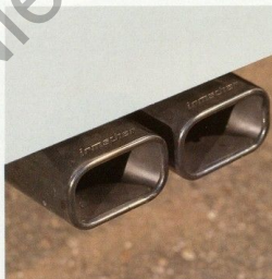
Nachschalldämpfer mit rechteckigem Doppel-Endrohr.
