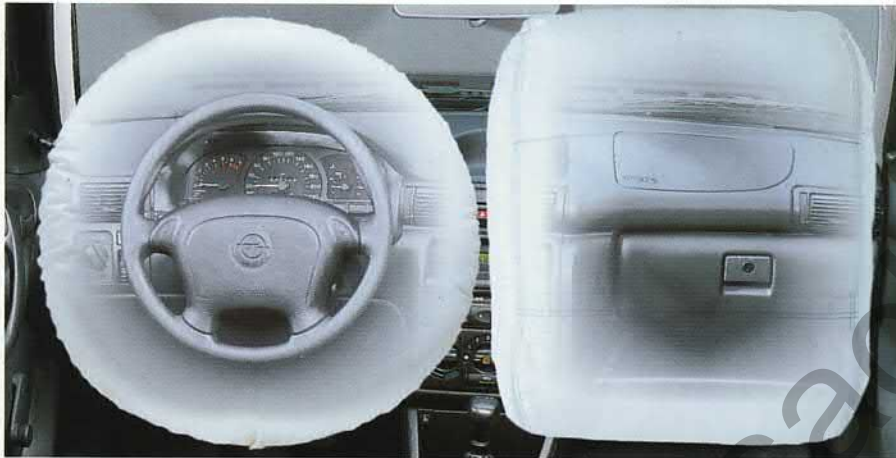
Eine intelligente Elektronik entscheidet in Millisekunden über die Aktivierung der Airbags.
