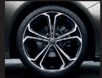
Leichtmetallräder im „5-Doppelspeichen“-Design, BiColor, 8½ J x 20 mit Reifen 245/40 R 20 (RQA).
