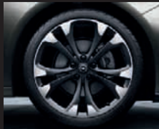
Leichtmetallräder im „5-Doppelspeichen“-Design, 8½ J x 20 mit Reifen 245/40 R 20 (RTH).
