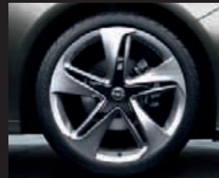
Leichtmetallräder im „5-Sternspeichen“-Design, 8½ J x 20 mit Reifen 245/40 R 20 (RQ9).
