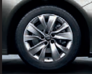
Leichtmetallräder im „5-Doppelspeichen“-Design, 7½ J x 18 mit Reifen 235/50 R 18 (RQH).
