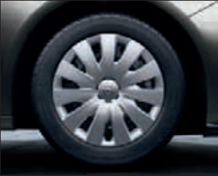
Stahlräder mit ganzflächiger Abdeckung, 7 J x 17 mit Reifen 235/55 R 17 (PWP). Serie für Edition in Verb. mit Benzinmotoren.
