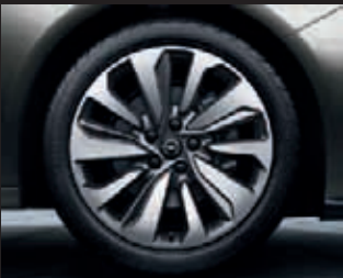
Leichtmetallräder im „10-Speichen“-Design, 8 J x 19 mit Reifen 235/45 R 19 (RVB).
