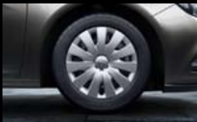
Stahlräder mit ganzflächiger Abdeckung, 7 J x 17 mit Reifen 235/55 R 17 (PWP). Serie für Edition in Verb. mit Benzinmotoren.
