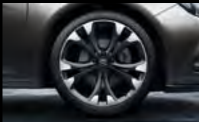
Leichtmetallräder im „5-Doppelspeichen“- Design, 8 1/2 J x 20 mit Reifen 245/40 R 20 (RTH).
