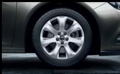
17"-Leichtmetallräder im „7-Speichen“-Design, 7 J x 17 mit Reifen 235/55 R 17 (RCN). Serie für Edition in Verb. mit Dieselmotoren.
