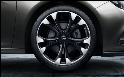
20"-Leichtmetallräder (5 Doppelspeichen), Diamond-Cut BiColor, Hochglanzschwarz, 8½ J x 20 mit Reifen 245/40 R 20 (Q7G). Erhältlich nur für Supreme-Paket.
