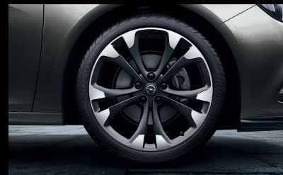
20"-Leichtmetallräder (5 Doppelspeichen), 8½ J x 20 mit Reifen 245/40 R 20 (RTH).
