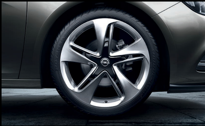
20"-Leichtmetallräder (5 Sternspeichen), 8½ J x 20 mit Reifen 245/40 R 20 (RQ9).
