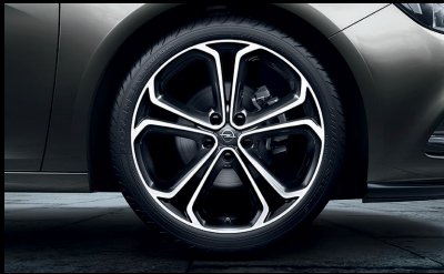
20"-Leichtmetallräder (5 Doppelspeichen), BiColor, 8½ J x 20 mit Reifen 245/40 R 20 (RQA).
