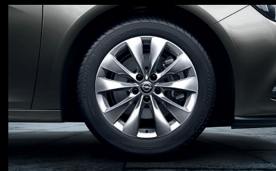
18"-Leichtmetallräder (10 Speichen), 7½ J x 18 mit Reifen 235/50 R 18 (RQJ). Serie für INNOVATION und Ultimate.
