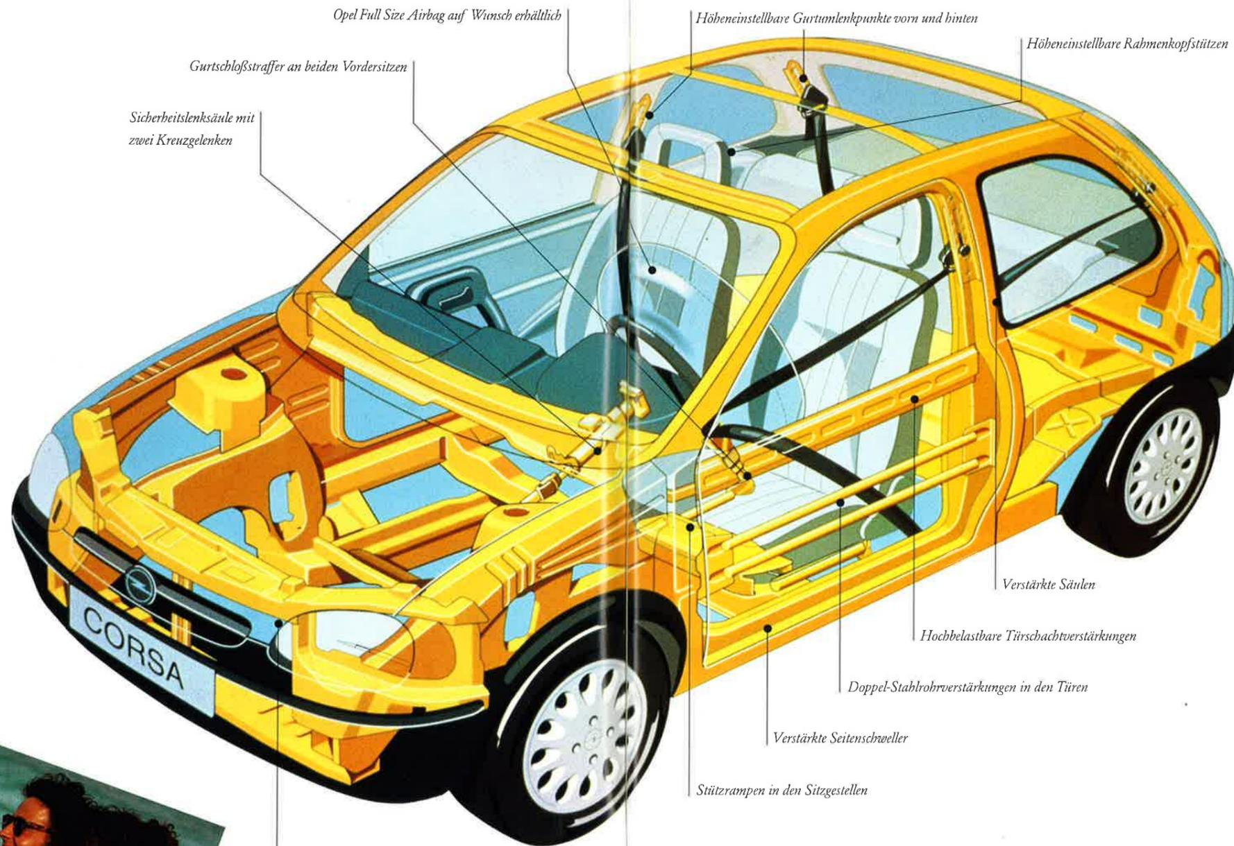
Karosserie mit 40 Prozent höherer Torsionssteifigkeit als beim Vorgängermodell
