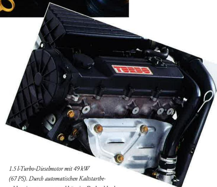
*1.5 l-Turbo-Dieselmotor mit 49 kW (67 PS). Durch automatischen Kaltstartbeschleuniger, temperaturabhängige Drehzahlanhebung und elektronisch gesteuertes Vorglühsystem ist dieser moderne Turbodiesel ein problemloser Starter. Hohe Elastizität und ausgezeichnete Beschleunigungswerte zeichnen diesen Motor aus. Der Corsa ist der einzige seiner Klasse, der mit einem Turbodiesel erhältlich ist.*
