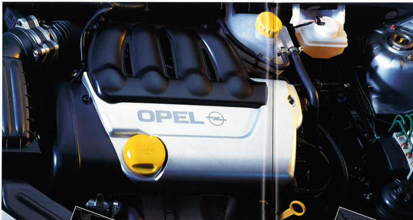
*Neu! 1.6i-16V-ECOTEC mit 80 kW (109 PS). Sein maximales Drehmoment von 150 Nm erreicht er schon bei 3800 min<sup>-1</sup>, was ihn in den unteren Drehzahlbereichen besonders spritzig und kraftvoll beschleunigen läßt. Ausgestattet mit modernem Multi-Point Einspritzsystem „Multec S“, verteilerloser Direktzündung, selektiver Klopfregelung.*
