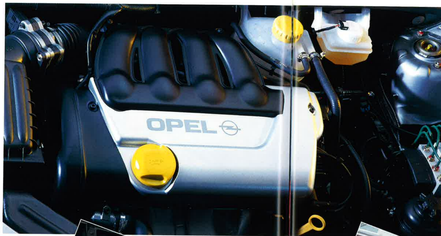
1.6-16V-ECOTEC mit 80 kW (109 PS). Sein maximales Drehmoment von 150 Nm erreicht er schon bei 3800 min -1 , was ihn in den unteren Drehzahlbereichen besonders spritzig und kraftvoll beschleunigen läßt. Ausgestattet mit modernem Multi-Point-Einspritzsystem „Multec S“, verteilerloser Direktzündung, selektiver Klopfregelung.
