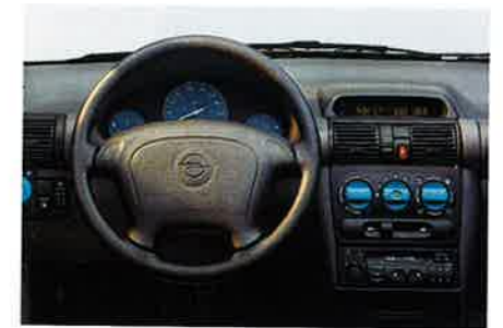
Auf der Fahrerseite befindet sich der Opel Full Size Airbag in dem speziellen Airbag-Lenkrad des Corsa.
