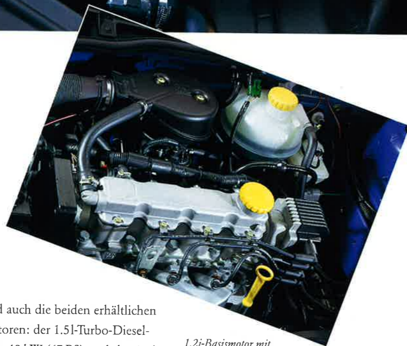
1.2i-Basismotor mit 33 kW (45 PS). Mit diesem Motor haben die Opel Ingenieure konsequent ökologische Anforderungen umgesetzt. Z. B. durch das elektronisch gesteuerte Ventil der Abgasrückführung, das er als einziger seiner Klasse hat und das den Verbrauch sowie Schadstoffausstoß deutlich senkt.
