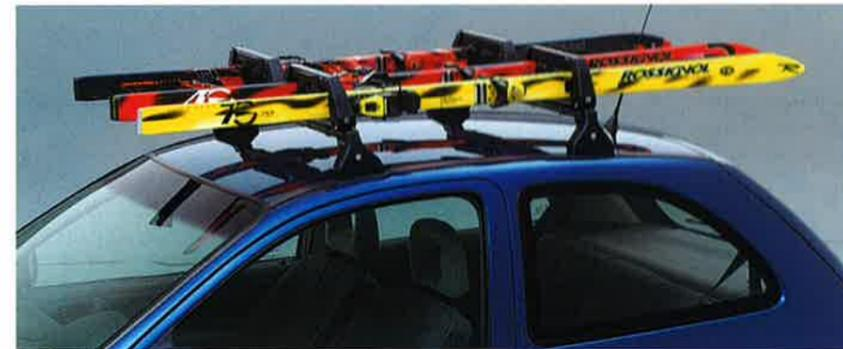
*Transportieren mit System. Auf dem Basissträger lassen sich verschiedene Spezialträger montieren, z.B. der abschließbare Skiträger mit Platz für 6 Paar Ski und zwei Snowboards.*
