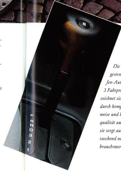
*Die elektronisch gesteuerte 4-Stufen-Automatik mit 3 Fahrprogrammen zeichnet sich nicht nur durch kompakte Bauweise und hohe Schaltqualität aus, sondern sie sorgt auch für überraschend niedrige Verbrauchswerte.*
