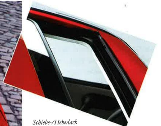
*Schiebe-/Hebedach mit getöntem Glas und ganzflächiger Sonnenblende. Das Dach lässt sich vollständig öffnen oder in eine Entlüftungsstellung kippen.*
