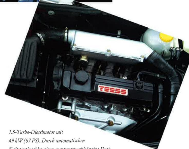
*1.5-Turbo-Dieselmotor mit 49 kW (67 PS). Durch automatischen Kaltstartbeschleuniger, temperaturabhängige Drehzahlhebung und elektronisch gesteuertes Vorglühsystem ist dieser moderne Turbodiesel ein problemloser Starter. Hohe Elastizität und ausgezeichnete Beschleunigungswerte zeichnen diesen Motor aus.*
