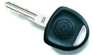
*Die serienmäßige elektronische Wegfahrsperre im Corsa schärft sich durch das Ausschalten der Zündung sofort und vollautomatisch.*
